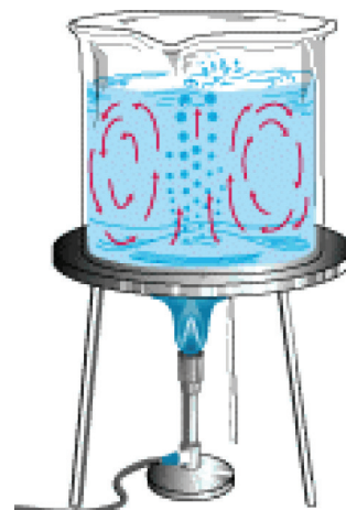
Sumber: http://pubs.usgs.gov/ Gambar 5.27. Proses konveksi pada air yang dipanaskan
